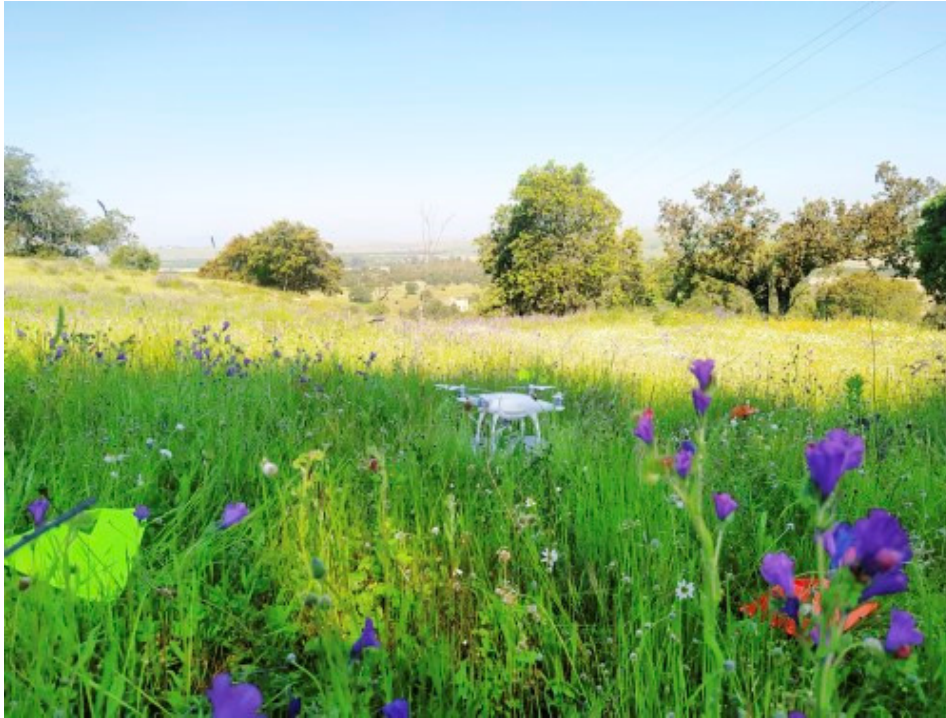
Dron a punto de despegar para sobrevolar con cámara multispectral una dehesa extremeña.
