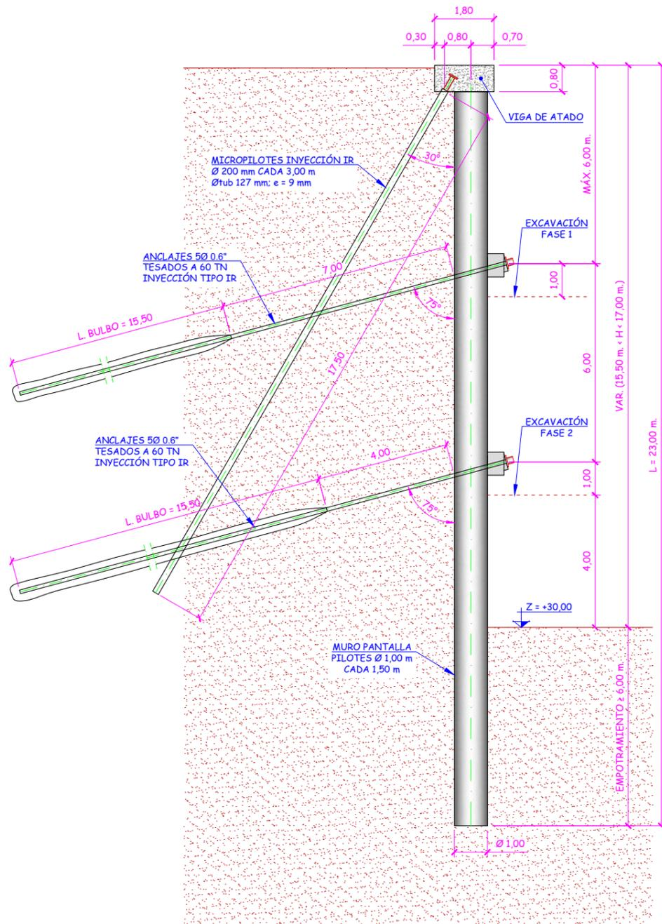
SECCIÓN TRANSVERSAL TIPO 1 H. máx. = 17,00 m.
