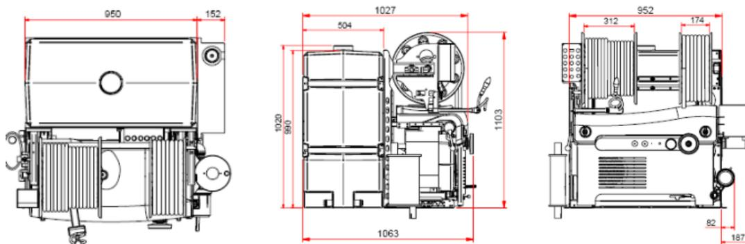
**Todo el equipo debe de venir montado como un conjunto compacto sobre bastidor para poder montarlo y retirarlo según necesidades sobre pick up, bien sea con carretilla elevadora o eslingado con camión pluma. Las dimensiones de la caja son 1400x1400x1200 mm (lxaxh), no debiendo de sobrepasar el conjunto las medidas de 1300x1200x1105 mm (lxaxh).**
